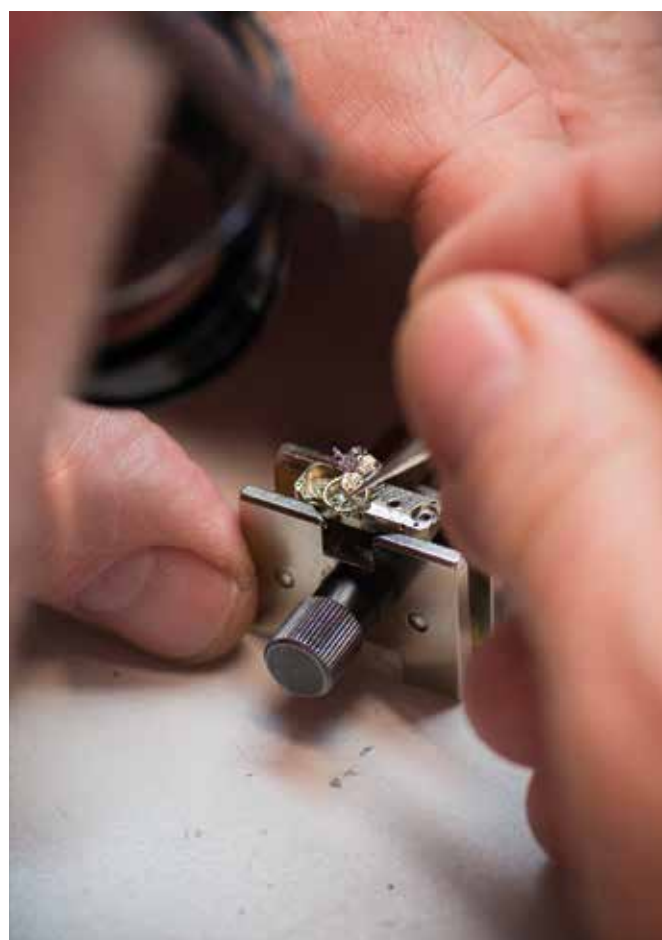
Remplacement de l'échappement.
